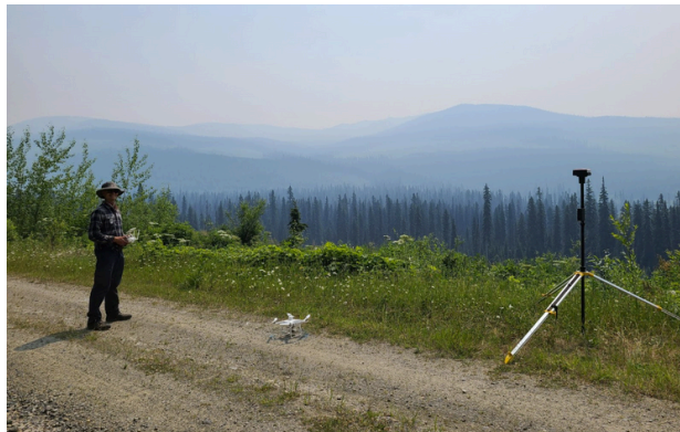
Image 3. Il est essentiel de placer votre station RTK dans un endroit où le signal radio n'est pas gêné par la topographie et par la végétation. Utilisez la topographie naturelle et les clairières à votre avantage pour vous assurer que le signal ne soit pas perdu pendant le vol.
