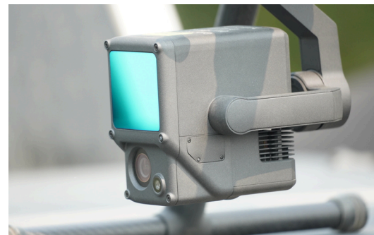
Image 2. Capteur lidar DJI L1 avec cardan de stabilisation - Quesnel, BC, 2022. Image de L. Irwin.
